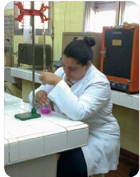
■ Titulación ácido base en laboratorio
